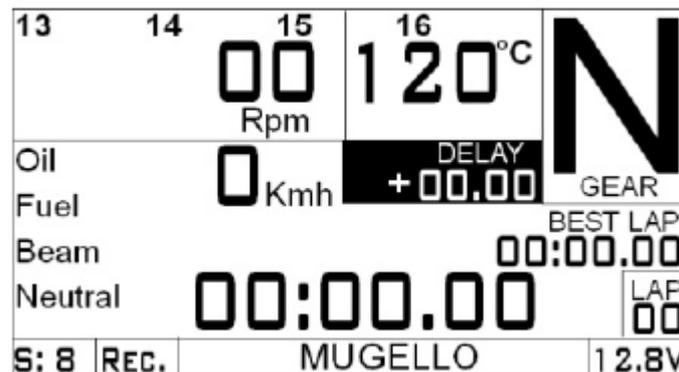
Wenn das DaVinci aufnimmt, blinkt die Aufnahmeanzeige „REC“ unten im Display und die REC LED leuchtet.
